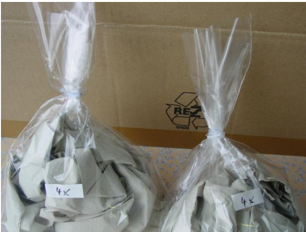
Abfallbeutel mit Papier gefüllt und mit halbem Parafilmstreifen verschlossen. Der Parafilm wurde 4x um den Beutel gewickelt. Foto vor dem Autoklavieren.
