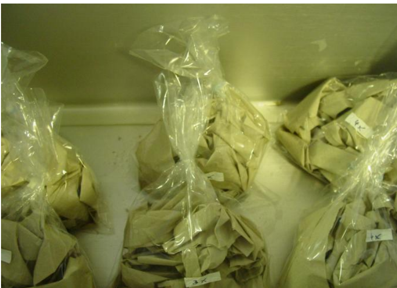
Abfallbeutel mit Papier gefüllt und mit halbem Parafilmstreifen verschlossen. Der Parafilm wurde 2-4x um den Beutel gewickelt. Foto nach dem Autoklavieren. Die Beutel haben sich zum Teil leicht geöffnet.
