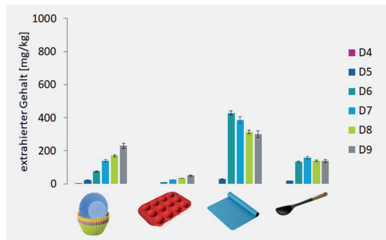
Abbildung 49: Cyclosiloxane (D4, D5, D6, D7, D8, D9) in belasteten Lebensmittelbedarfsgegenständen aus Silikon
