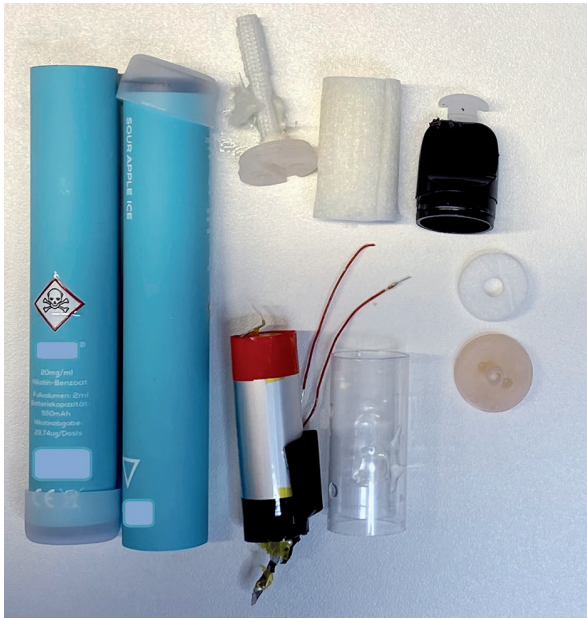
Abbildung 54: Bauteile einer Einweg-E-Zigarette
